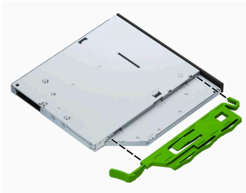
6. Schieben Sie das optische Laufwerk durch die Frontblende (1) vollständig in den Schacht hinein, bis der grüne Freigaberiegel am Gehäuserahmen einrastet (2).
