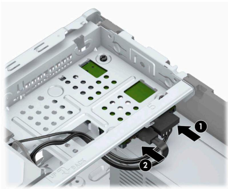
5. Bei der Installation eines neuen Laufwerks verbinden Sie das andere Ende des Datenkabels mit dem entsprechenden Anschluss auf der Systemplatine.
