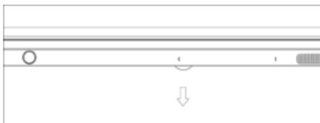
2. Insérez le module Wi-Fi dans l'IFP dans le sens de la flèche.
