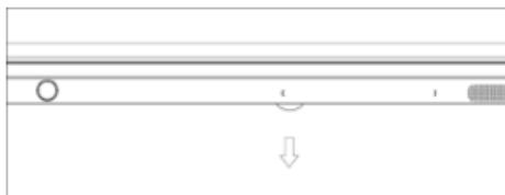
2. Das WLAN-Modul in Pfeilrichtung in das IFP einsetzen.
